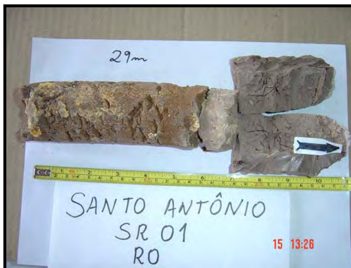
FOTO B.III. 16 – Segmento do testemunho do furo SR-01, Santo Antônio, com concentração de matéria orgânica
