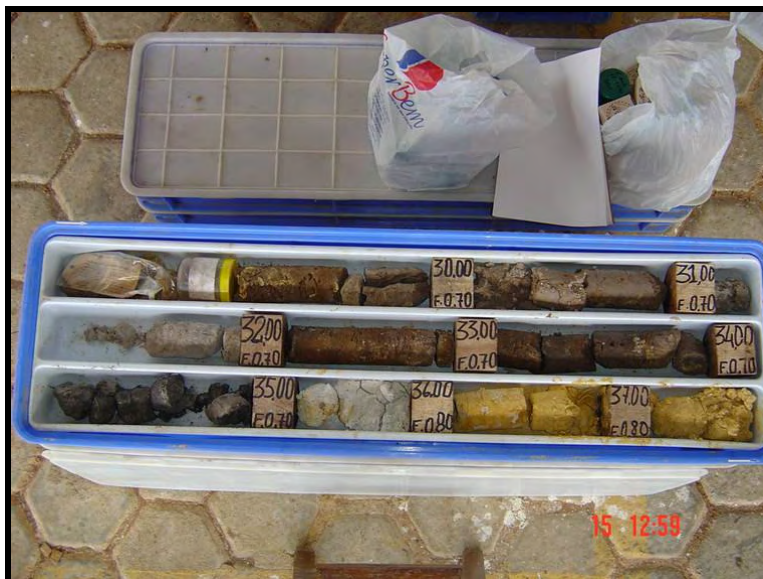
FOTO B.III. 14 – Testemunho de furo acondicionado para ser conservado no repositório do escritório de FURNAS, Porto Velho
