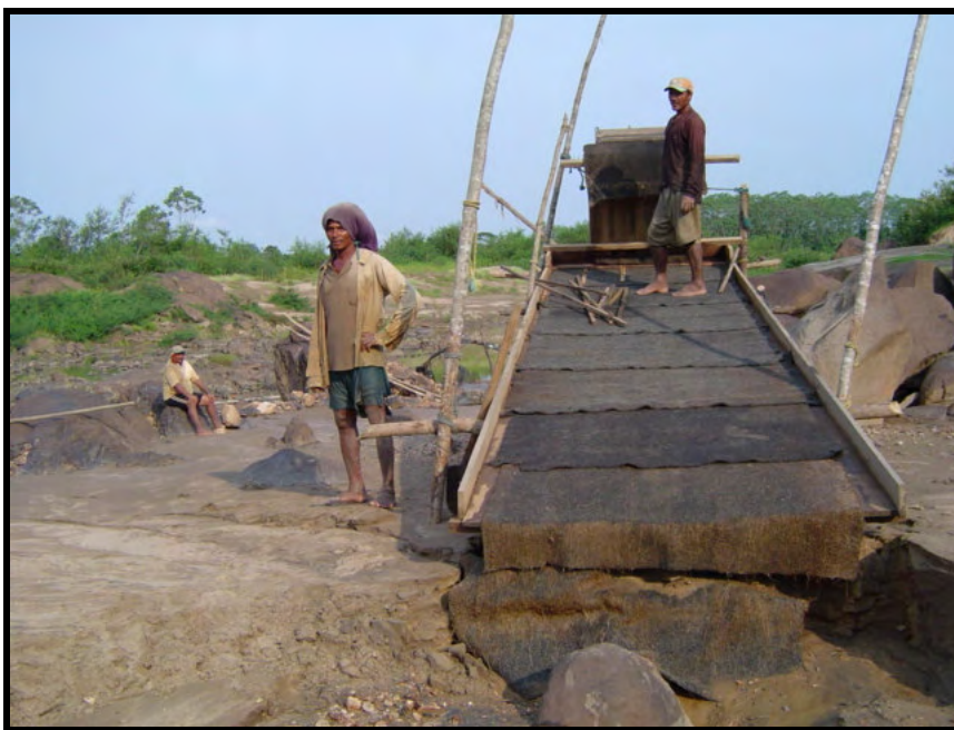
FOTO B.IV. 235 – Draga terrestre em ação (triturando a rocha), garimpo Sol Nascente
