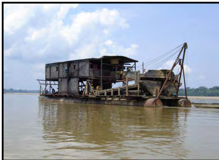
FOTO B.IV. 232 – Draga de lança, com residência flutuante.
